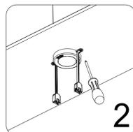
Faites attention à la direction ENTRÉE et SORTIE. Assurez-vous que la borne indiquant « AC IN » est dirigée vers votre prise. Tenez-la en place et insérez les vis de montage. Les vis fournies conviennent aux bas d'armoire de 1 cm (3/8 po) d'épaisseur ou plus.
